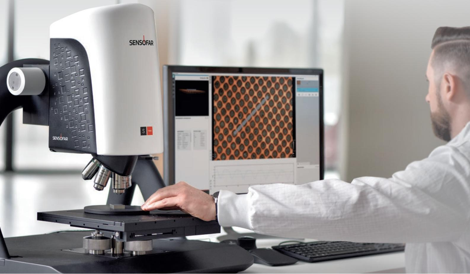
根据 ISO25178 和 ISO4287 计算表面参数。计算高度、空间、混合、功能和体积参数。
