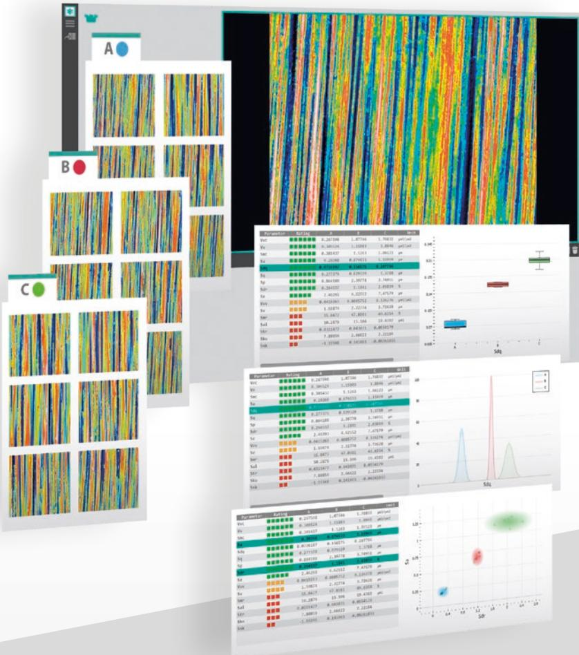
Инновационное решение для оптических профилометров, которое существенно повышает его удобство использования и упрощает задачу установки допусков при создании рецептуры, а также определения ключевых параметров управления производственной линией путем сравнения нескольких наборов данных. Специально разработан для пользователей, которым нужен отслеживаемый производственный контроль.
