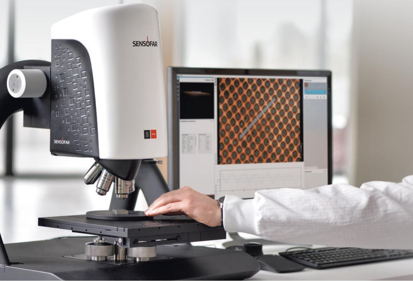
Параметры поверхности рассчитываются в соответствии со стандартами ISO 25178 и ISO 4287. Вычисляются высотные, пространственные, гибридные, функциональные и объемные параметры.
