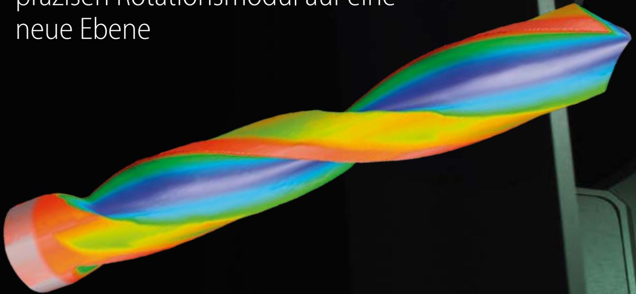
Das Gerät ermöglicht die dreidimensionale, automatische und positionsdefinierte Erfassung von Oberflächen, deren Daten zu umfassenden 3D-Volumenmessungen zusammengesetzt werden. Die S neox 3D-Messtechniken decken ein breites Spektrum an Größen ab, darunter Form (Ai Fokusvariation), Rauheit im Subnanometerbereich (Interferometrie) und kritische Abmessungen, die eine hohe laterale und vertikale Auflösung (konfokal) erfordern.
