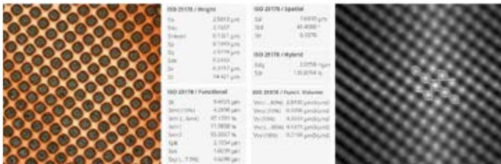
根据 ISO25178 和 ISO4287 计算表面参数。计算高度、空间、混合、功能和体积参数。
